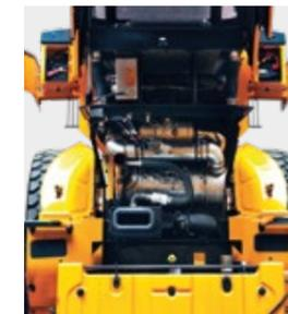
Le **capot moteur est entièrement rétractable** et peut être **ouvert électriquement** pour faciliter l'accès au compartiment moteur étanche et à la chambre de refroidissement. Le compartiment moteur est conçu de sorte à éviter tout risque de feu causé par l'entrée de corps étrangers.
