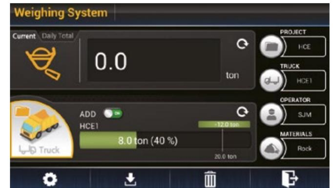
Le **système de pesage cumulatif automatique/manuel** de haute précision vous aide à gérer la production plus efficacement dans n'importe quel environnement. Pour une précision optimale, des icônes d'erreur de pesage et un indicateur de valeur de poids bicolore s'affichent à l'écran.
