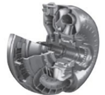
Le **verrouillage de différentiel hydraulique** en option empêche le patinage des roues, pour un fonctionnement plus sûr et une amélioration de la productivité et du rendement énergétique.
