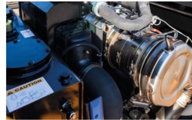
La HL980A est équipée de notre **système tout-en-un de post-traitement des gaz d'échappement** qui réduit les émissions et les coûts d'exploitation tout en améliorant la fiabilité et en simplifiant la maintenance.
