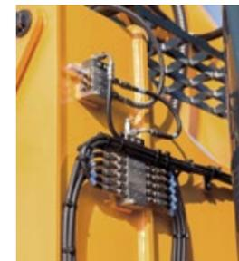
Avec le **système de graissage automatique** en option, la graisse est automatiquement appliquée aux points de lubrification quand c'est nécessaire. Le dosage correct est garanti et le lubrifiant est appliqué uniformément, ce qui réduit la consommation de graisse et élimine les déchets.
