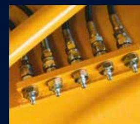
Port d'injection de graisse centralisé
