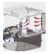
Le système de climatisation est installé sur le côté droit de la cabine pour faciliter l'entretien et le remplacement du filtre. Il est doté d'un filtre interne de grande capacité et d'un matériau filtrant spécialement sélectionné pour ses performances supérieures.
