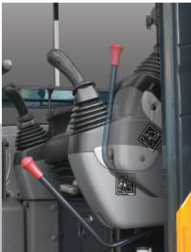
La console gauche est escamotable et facilite l'accès à la cabine et la sortie de l'opérateur.
